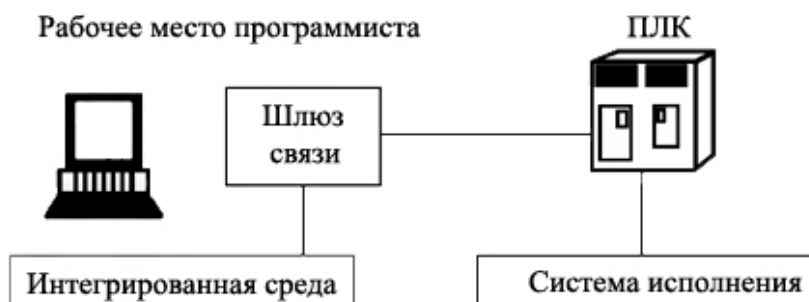
Рис.4. Соединение интегрированной среды программирования с ПЛК
