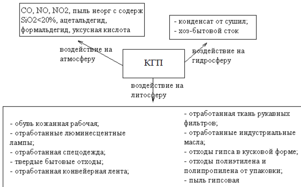
Рис. 2. Схема с указанием загрязняющих веществ, отходов производства и отработанных вод от цеха по производству КГП
